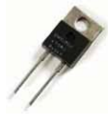
470 Ω, 35 W Resistor de potencia de película gruesa (b)
